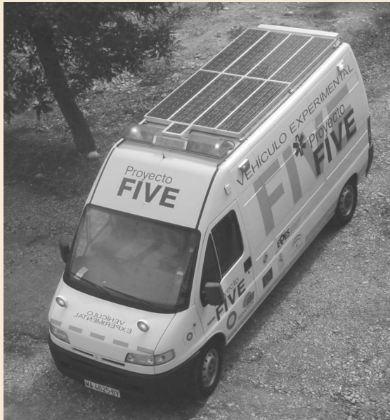
Figura 7. Integración de un sistema fotovoltaico en un vehículo de emergencias sanitarias. El proyecto "FIVE"
